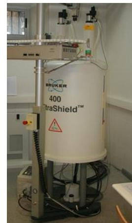
**Espectrómetro de RMN** **Espectrómetro de masas**
