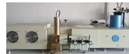
**Espectrofotómetro de fluorescencia**
